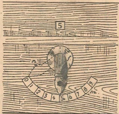
Fig. 18. Et stykke av kassen med begge lokene paa, visende den øverste arm med haandtak og den paa loket fastlimede papirstrimmel (m) med tal. For at haandsvinget ikke skal gli for langt til siden, slaas en liten stift (n) i loket.
