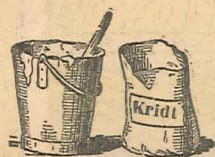
Fig. 1. Til hvitning av tak brukes vandrevet kritt utrørt i vand.
