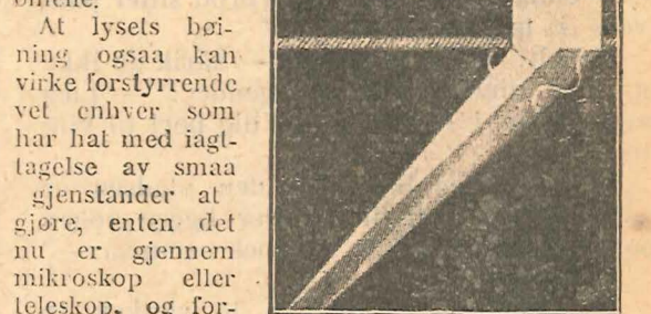
9. Er det mellem lysstrålene en hel bølgekændes forskjell, vil den ene halvdel av strålene helt ophæve den anden, og resultatet blir da fuldstændig mørke.
