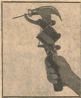
Fig. 1. Ved hjelp av dette paa hammerkaflet anbragte sindrige lille apparat er man istand til at slaa spiker i med bare en haand, idet hammeren saa at si selv tar frem spikerne.
